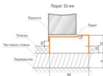
Схемы порогов для технических дверей EI-O (толщина полотна 60 мм)
